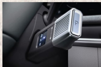
Botonera de cambios eléctrico (SBW)
