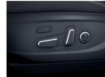
Asiento del conductor eléctrico de 8 posiciones con soporte lumbar de 2 posiciones
