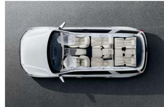
Sistema de 7 airbags (airbags para los asientos delanteros, airbags laterales delanteros, airbags para las rodillas del conductor y airbags de cortina resistentes a vuelcos)
