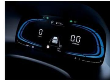
Panel de instrumentos de supervisión LCD de TFT de 4.2"
