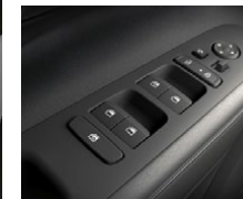
Control eléctrico de ventanas y espejos exteriores plegables.
