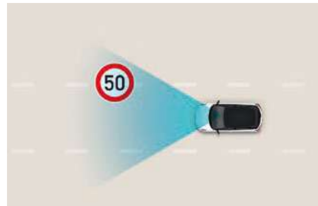
Asistente de límite de velocidad (SLA). Las funciones de conducción semiautónoma identifican las señales de la carretera y ajustan la velocidad del coche a los límites establecidos (cuando el sistema está activado).
