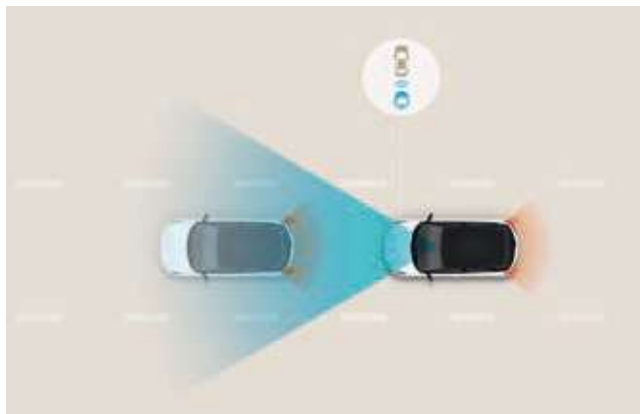
Sistema de asistencia a la frenada de emergencia (FCA). Detiene el coche rápidamente, incluso si estás distraído. El FCA te alerta cuando detecta vehículos que reducen la velocidad o se detienen, así como ciclistas o peatones en la vía, y frena a fondo si no reaccionas a tiempo.
