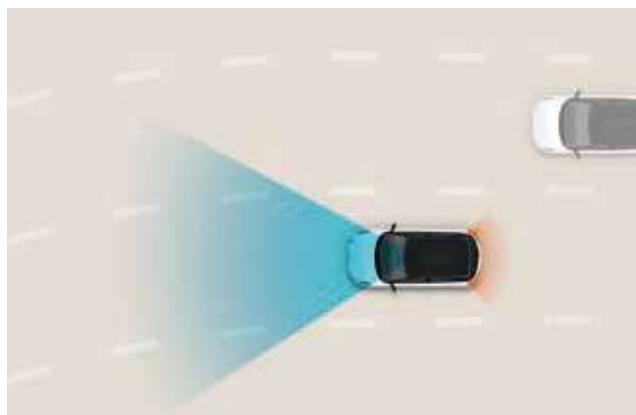
Control de crucero inteligente (SCC). Utiliza el sistema de navegación de última generación para anticiparse a las curvas y rectas de la autopista y ajusta automáticamente la velocidad para una conducción más segura. Asimismo, si está activado, la velocidad se ajusta automáticamente cada vez que cambian los límites de velocidad señalizados en la carretera.
