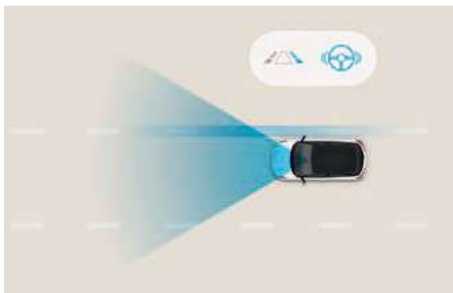
Sistema activo de cambio involuntario de carril (LKA). Te ayuda a mantenerte en el buen camino. El LKA emite alertas visuales y sonoras si empiezas a desplazarte fuera del carril sin señalar la maniobra e inicia sutiles correcciones en la dirección para devolverte al carril.
