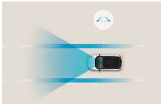
Asistente de seguimiento de carril (LFA). Te mantiene centrado y más seguro. Cuando se activa, este sistema mantiene el vehículo centrado en su carril a velocidades de entre 0 y 185 km/h en ciudad y carretera.
